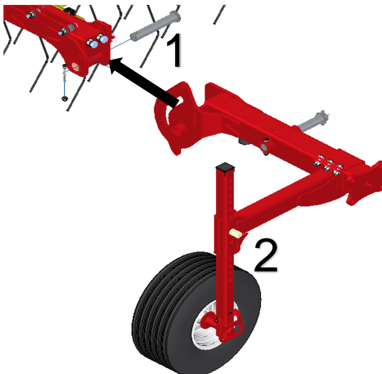
Illustration 20 : montage du cadre latéral sur le cadre principal de l'AS 900 M1 pliage à ciseaux
