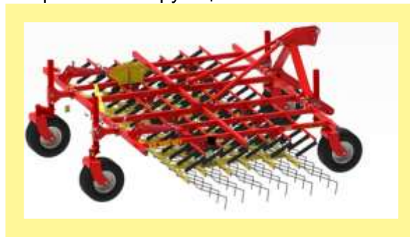
Рис. 11: Передняя навеска с 4 копирующими колесами
