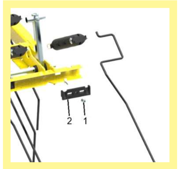
Рис. 15: 1 = гайка, 2 = пластмассовая деталь
