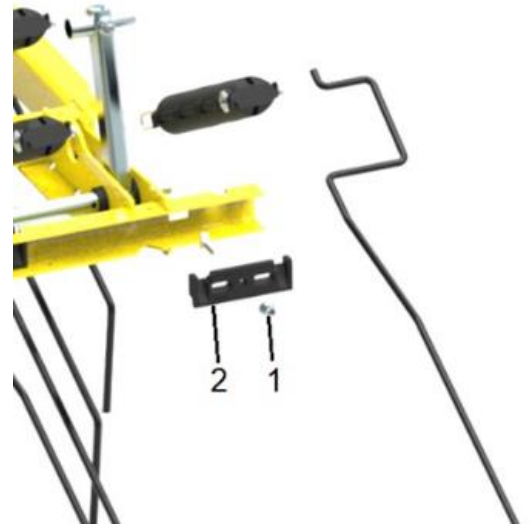
Obrázek 18: 1 = matice, 2 = plastový výlisek
