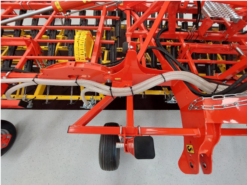
Abbildung 67: Schlauchverlegung entlang des Striegels 3
