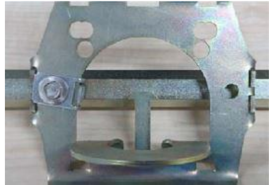
Abbildung 42: Auf der Sechskantstange aufgefädertes und befestigtes Prallblech
