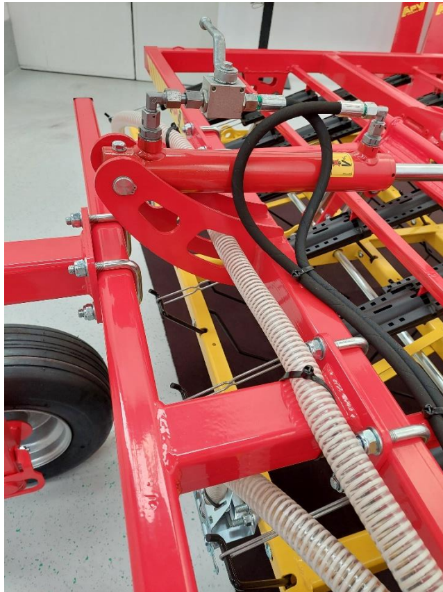
Abbildung 71: Schlauchverlegung entlang des Striegels 7
