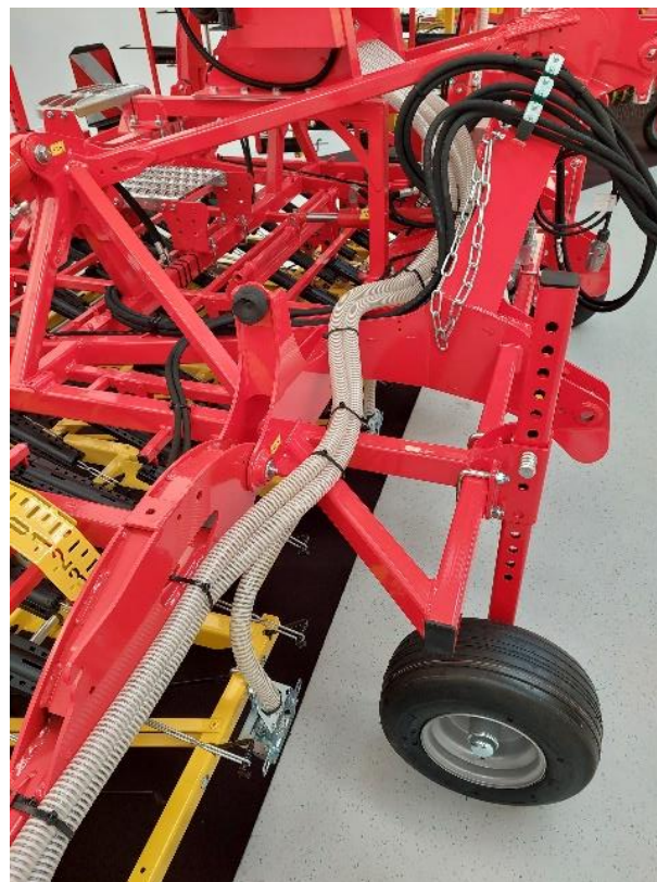
Abbildung 66: Schlauchverlegung entlang des Striegels 2
