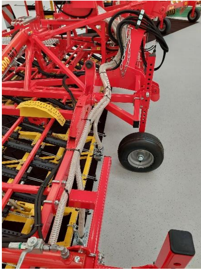
Abbildung 69: Schlauchverlegung entlang des Striegels 5
