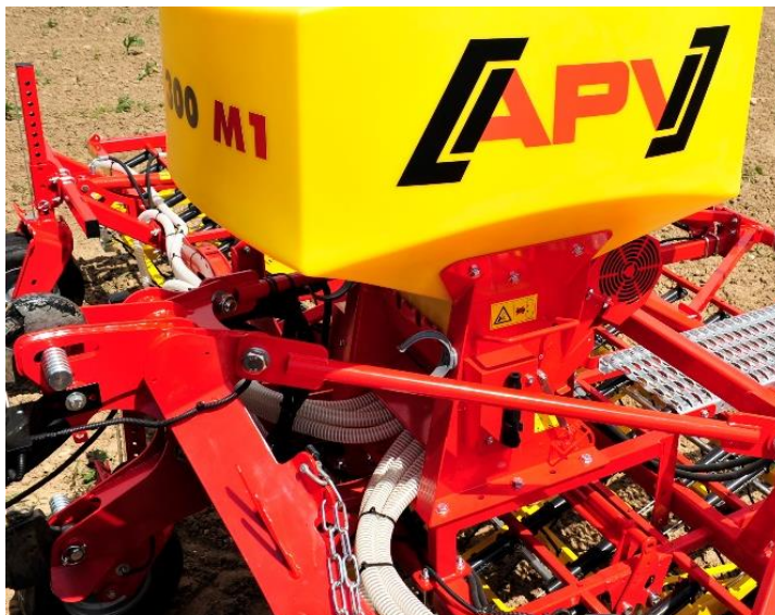
Abbildung 61: Schlauchverlegung vom PS ausgehend 1
