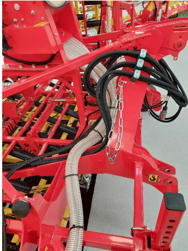
Abbildung 65: Schlauchverlegung entlang des Striegels 1
