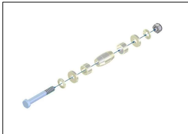
Figure 7 : structure des boulons de blocage
