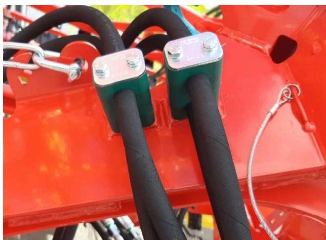
Figure 21 : colliers de serrage sur le support de montage
